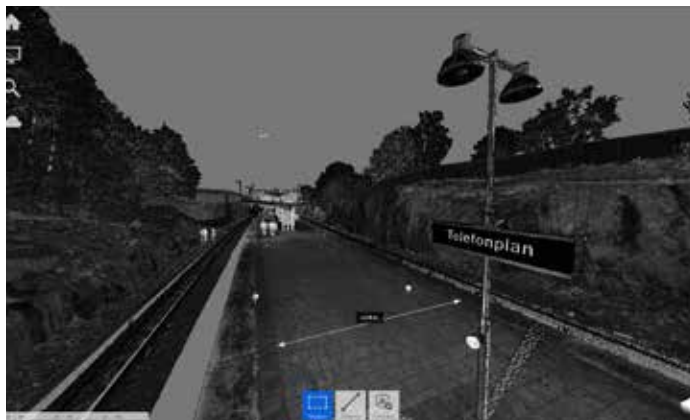
Punktmoln från laserskanning av Telefonplans tunnelbanestation inför arbete med överdäckning.
